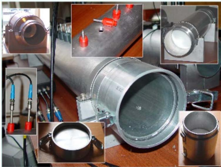
Bild I: Messapparatur zur Bestimmung der Absorberkennwerte.
