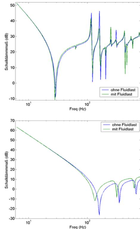
Abbildung 3: Schalldämmmaß einer a) schweren Platte (oben); b) leichten Platte (unten).
