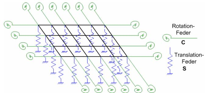
Abbildung 2: Platte befestigt an unendlicher Wand durch Feder-elemente.
