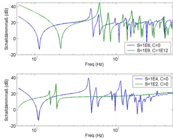
Abbildung 4: Schalldämmmaß einer Stahlplatte bei verschiedenen Randbedingungen.
